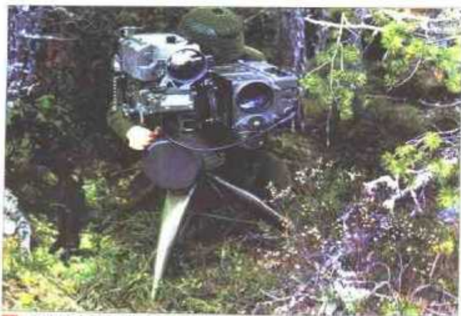
▲ “地狱火”导弹地面导引员正在使用激光指示器照射目标。
