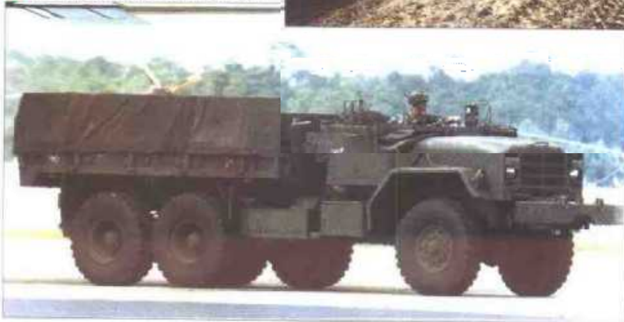
▼ M933拆去驾驶室后可用飞机空运。
